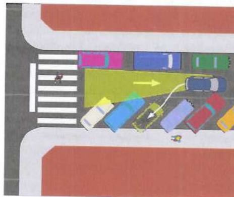
2.- Entrada a semibateria amb visibilitat suficient
