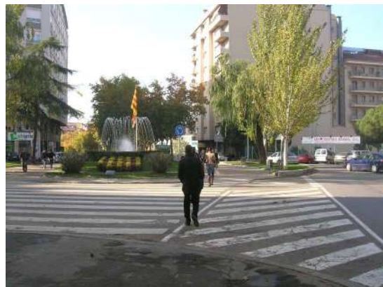
Imatge 25. Passeig Pere III, plaça de l'11 de setembre. Una rotonda no necessària talla el passeig dels vianants, que han de efectuar dos creuaments excessivament llargs i poc segurs.
