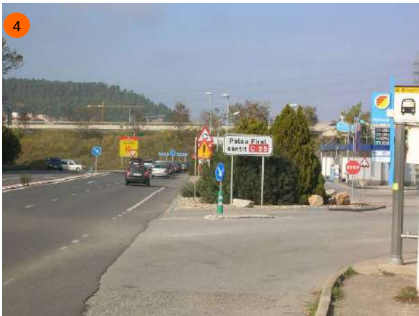
A la cantonada hi ha una parada d'autobús. La ubicació de la benzinera, darrera una vegetació força frondosa, significa que molts conductors no la veuen fins a l'últim moment. La combinació de frenades brusques i velocitats excessives pot causar accidents amb topades per darrera.
