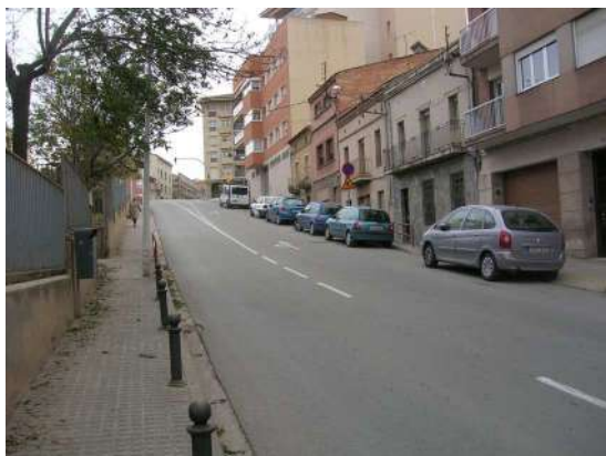
Imatge 20. Carrer Viladordis. Una vorera típica de Manresa amb una amplada de 1,5 m que es redueix a una amplada útil d'un metre just per la presència de pilones, fanals, papereres, etc.
