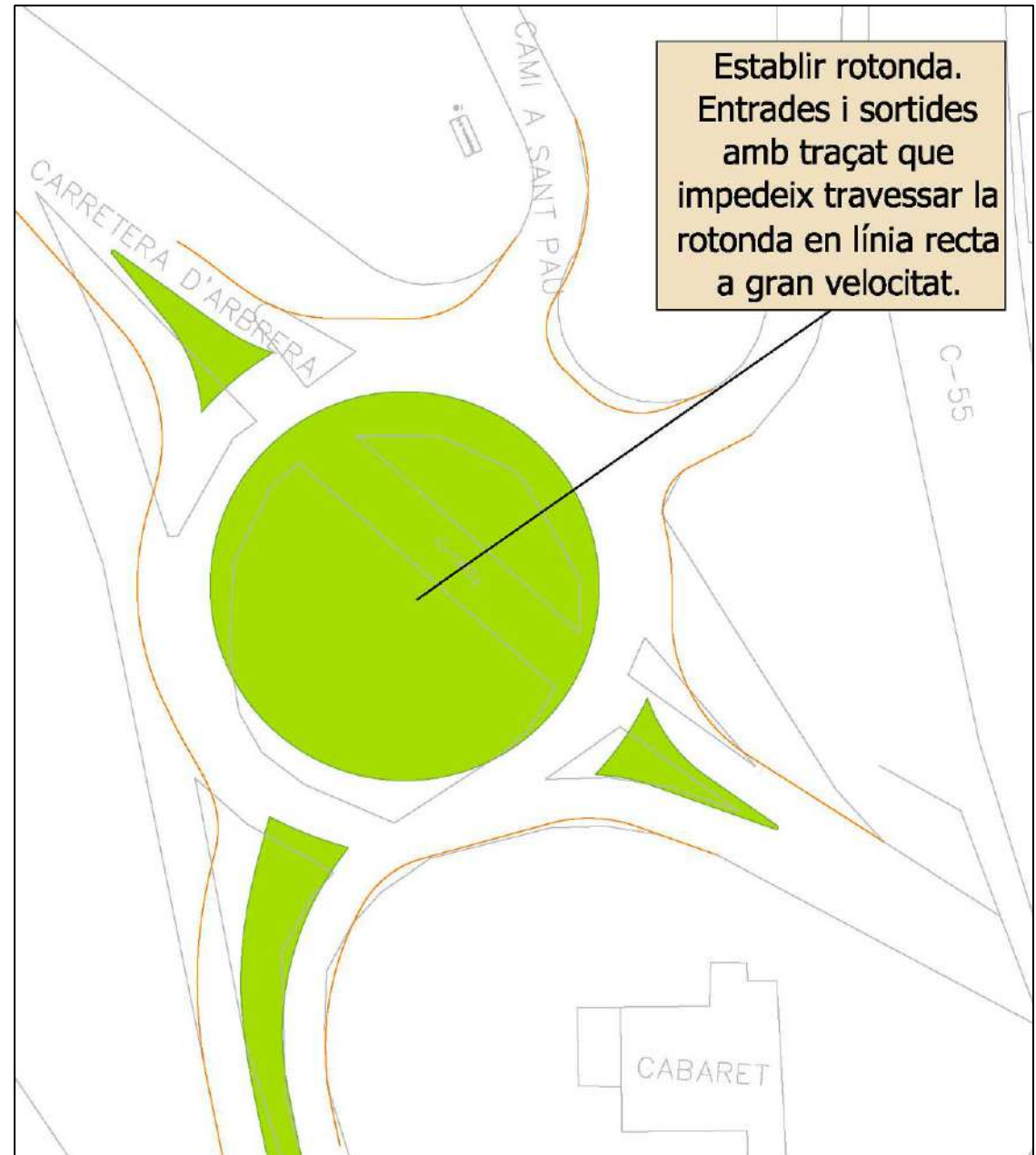
Esquema de la nova rotonda al nus entre la ronda Est i la carretera d'Arbrera
