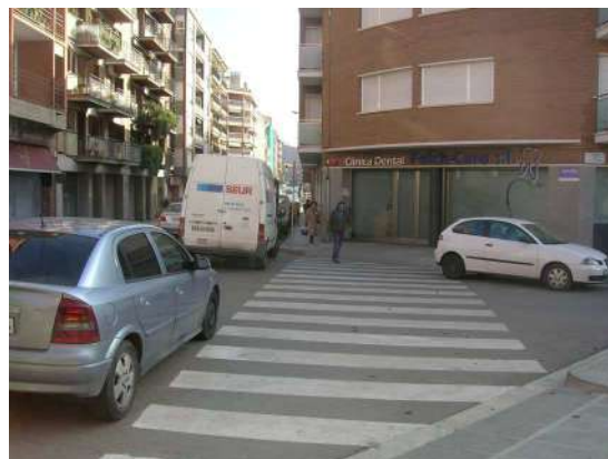
Imatge 11. Avinguda Tudela, intersecció passatge Can Saldes. L'absència d'orelles implica un pas de vianants molt llarg i una visibilitat nefasta per causa dels vehicles aparcats als xamfrans.
