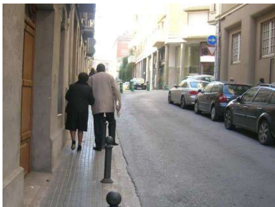
Imatge 18. Carrer Sant Fruitós. S'han posat pilones per a evitar l'estacionament irregular a la vorera, però l'espai restant per als vianants queda tan reduït que dificulta sèriament la mobilitat dels vianants.
