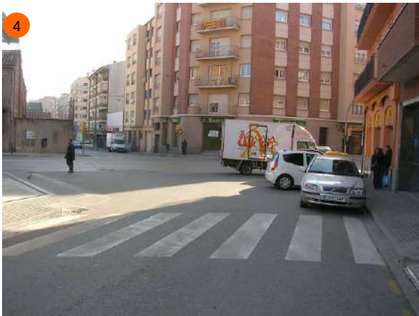
Carrer Indústria, intersecció amb la carretera de Vic. Un ampli espai mort provoca estacionament poc ordenat a i ha obligat allunyar el pas de vianants de la intersecció. Els vianants, conseqüentment, creuen fora del pas.
