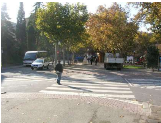
Imatge 9. Passeig Pere III, plaça d'Espanya. Un ampli espai mort allarga innecessàriament el pas de vianants i incita a maniobres irregulars.
