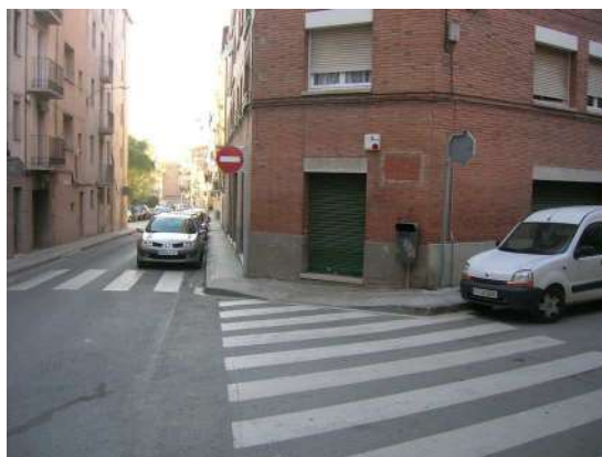
Imatge 4. Carrer Nou de Santa Clara, intersecció amb carrer Purgatori. Exemple de passos de vianants sense senyalització vertical. També manquen orelles i, a un dels passos, guals.
