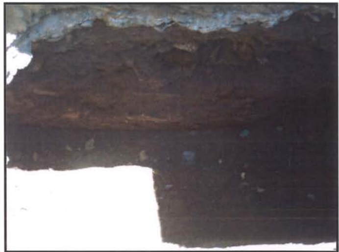
Detall dels materials de rebliment a partir d'una cala efectuada per a l'emplaçament d'una grúa.
