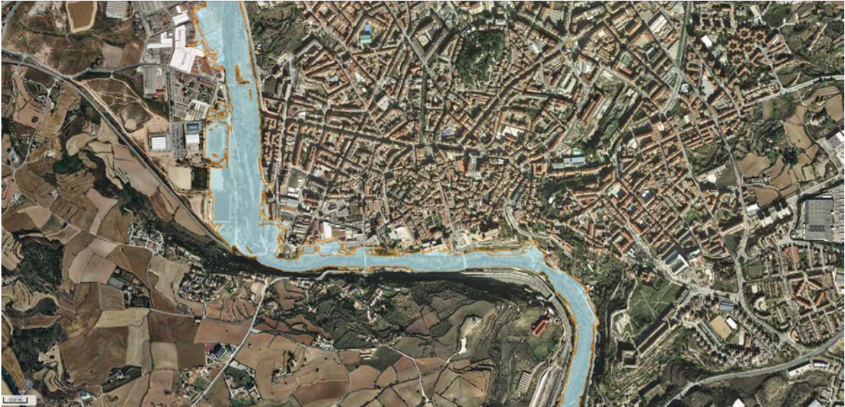
Figura 8. Mapa d'inundabilitat del tram urbà del riu Cardener a Manresa per a un període de retorn de 100 anys crescuda ordinària. Font: Visor cartogràfic de l'Agència Catalana de l'Aigua, 2018.
