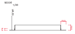
ESCOCELL CIRCULAR TIPUS E PER PAVIMENT LLOSA VULCANO JUNT OBERT (SÈQUIA)
