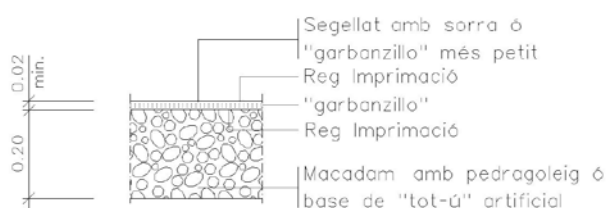
Paviment asfàtic D.T.S. Ferm vorera
