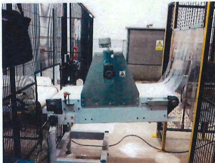
Fotografia 2: Conformador de sacs amb vibrador i corró aplanador.
