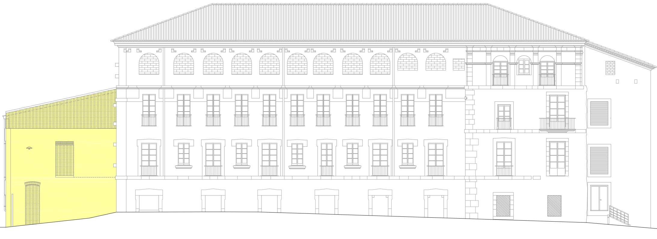
FAÇANA CARRER DE VIDAL I BARRAQUER PROPOSTA DE CONSOLIDACIÓ MITGERA EST DE L'ALA SUD
