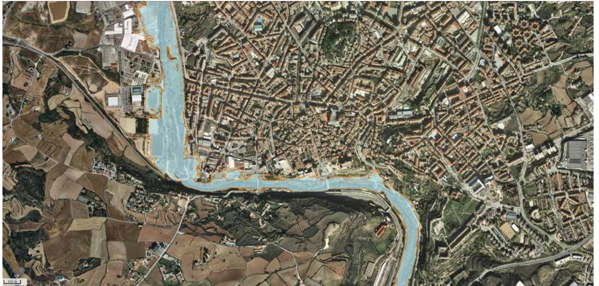
Figura 6. Mapa d'inundabilitat del tram urbà del riu Cardener a Manresa per a un període de retorn de 100 anys crescuda ordinària. Font: Visor cartogràfic de l'Agència Catalana de l'Aigua, 2018.
