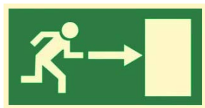
Figura 4. Pictograma per senyalitzar els trams dels recorreguts d'evacuació fins a sortides d'emergència d'acord norma UNE 23034:1998
