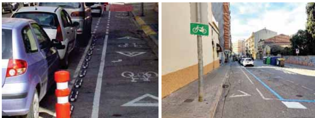
Figura 111. Exemples de protecció de carrils-bici
