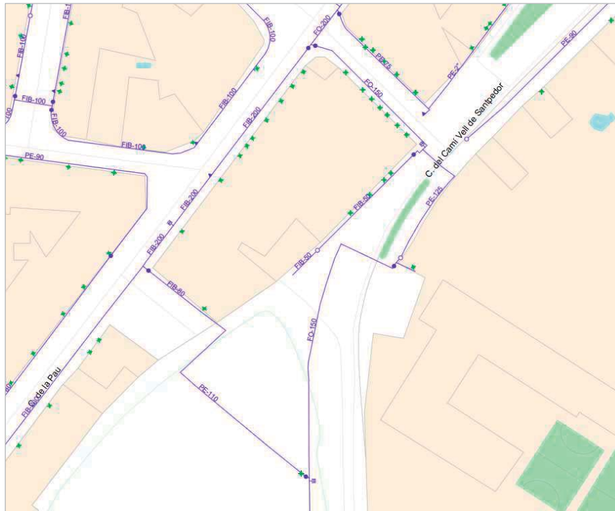
Esquema de la xarxa d'abastament facilitat per Aigües de Manresa.
