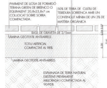
3) PAVIMENT FORMAT PER PEÇA DE FORMIGÓ TERANA GREEN DE 20,8x23,8x7 cm COL·LOCADA A TRENCALUNTES AMB DISTANCIA D'1,00 M ENTRE JUNTES DE 30 MM PEL CREIXEMENT DE GESPA SOBRE 4 CM D'UIL DE PERDUI I 30 CM DE GRAVA.
