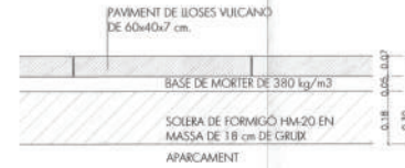
6) PAVIMENT DE LLOSES DE FORMIGÓ DE TIPUS VULCANO DE 60x40x7cm SOBRE SOLERA DE FORMIGÓ H4-20 EN MASSA DE 18 cm DE GRUIX. ÚS EN LES ZONES QUE ES TROBEN SOBRE ELS APARCAMENTS
