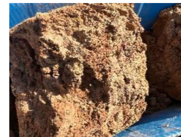
Fot. 2. Materials al·luvials fins que formen el nivell A
