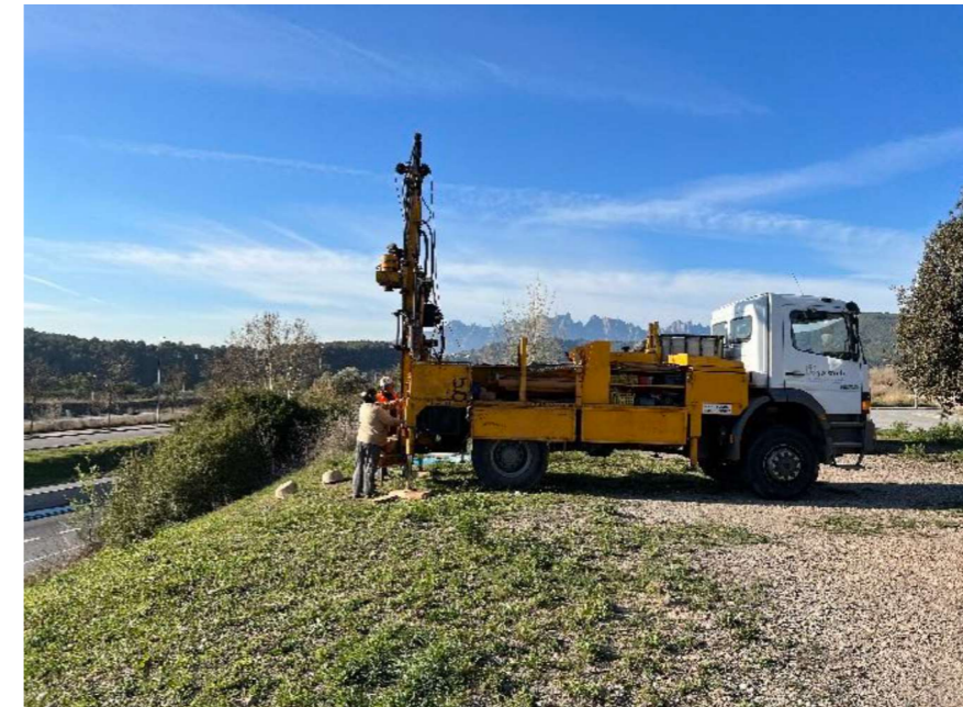
Fot. 3. Emplaçament del penetròmetre dinàmic en el punt de sondeig S1
