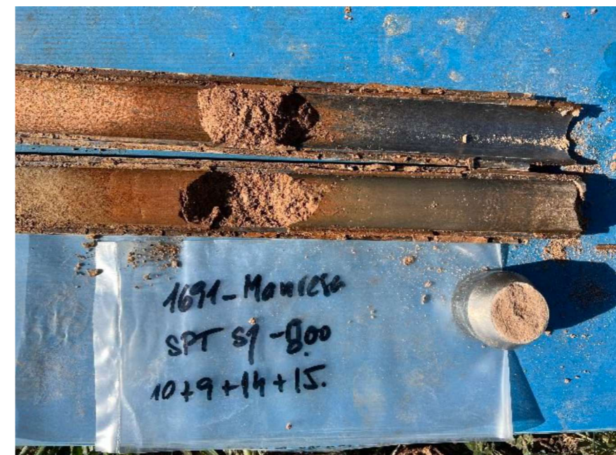
Fot. 4. Materials del nivell A extrets en el sondeig S1 a -8,00 m
