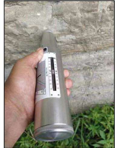
Foto 3. Mesura de la resistència amb escleròmetre.
