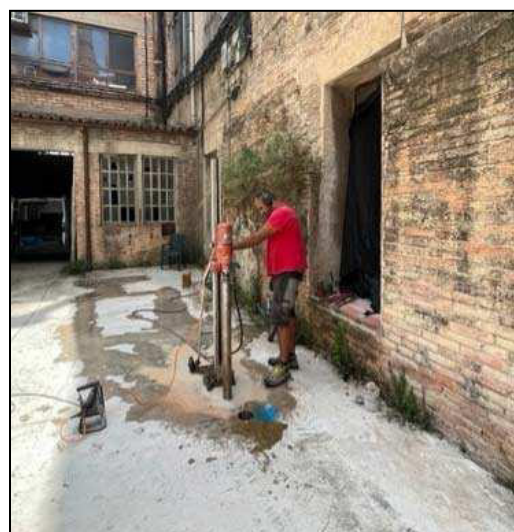
Foto 5. Execució del sondeig a testimoni S1 amb màquina perforadora Hilti
